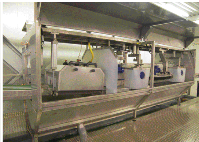
Direct na het opleggen wordt de prei ingekort (rechts), links de normaliter niet gebruikte wasunit.
