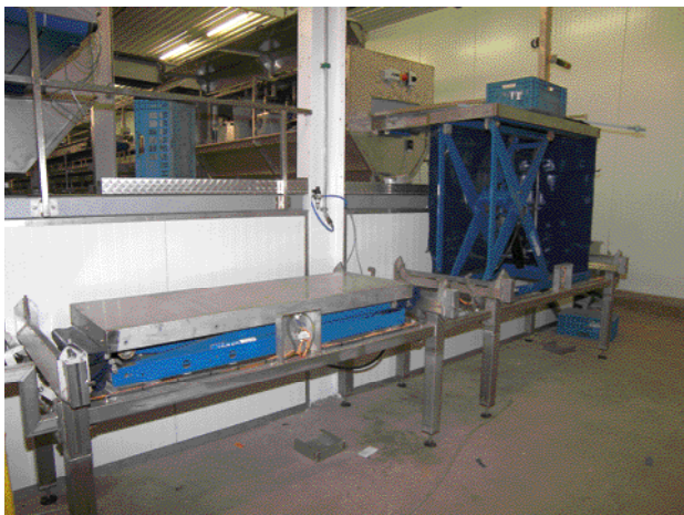
Het begin van de verwerkingslijn, met op de begane grond de schaar tafels voor het leeg drukken van de preirekken.
