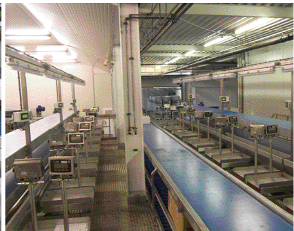
Maximaal tien schoners per werklijn. Dit aantal is makkelijk aan te passen.
