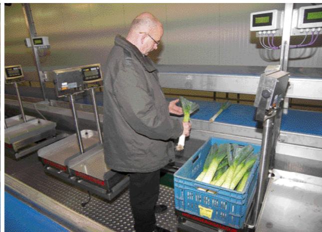
Een indruk van het inpakken. De prei wordt aangevoerd op twee boven elkaar liggende transportbanden.
