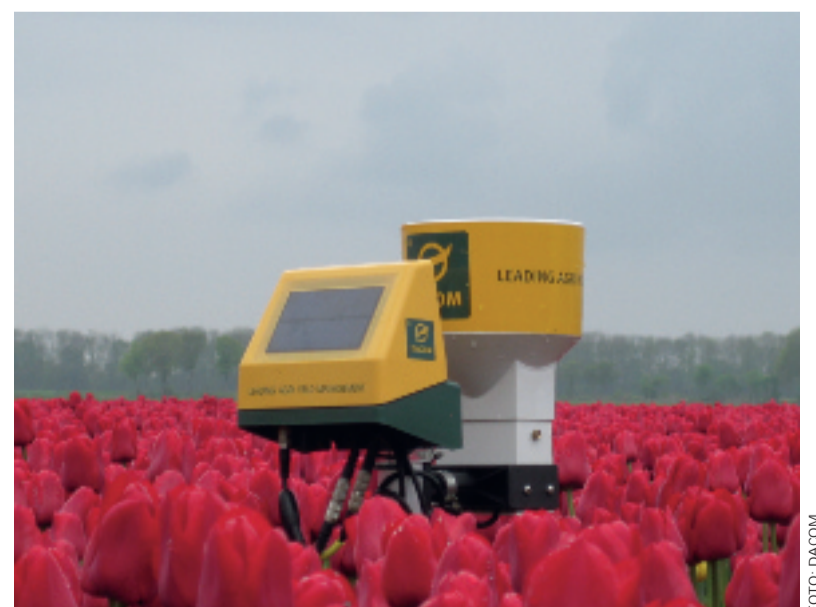
Het vochtstation van Dacom maakt 'bereggenen op maat' op eenvoudige wijze mogelijk.
