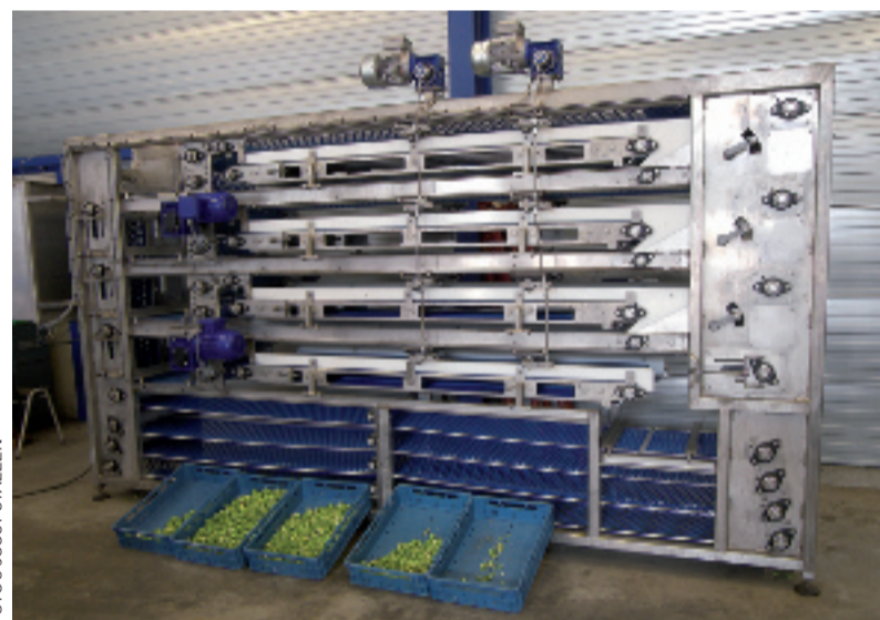
GEGE Machinebouw kwam twee jaar geleden met een sorteerflat voor ronde producten als spruiten en bollen.
