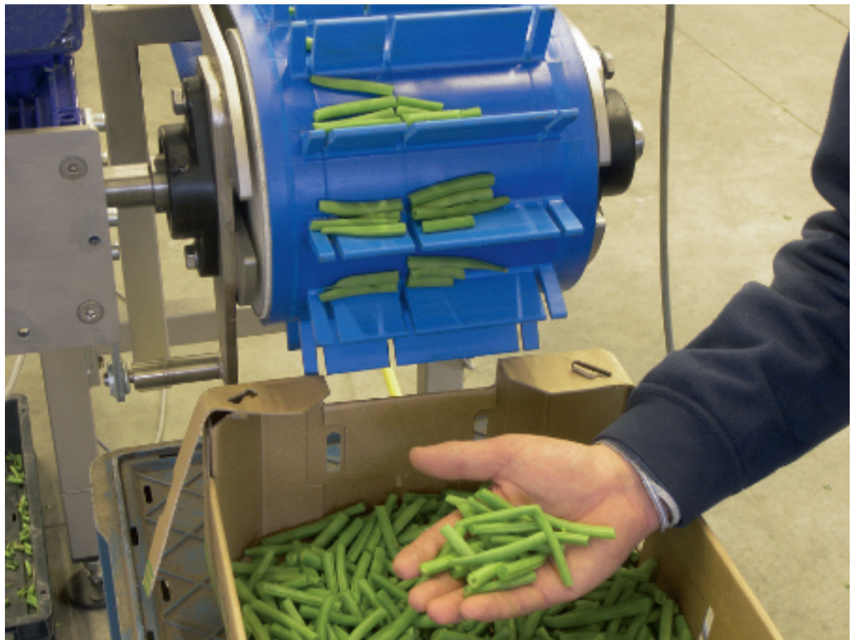
De bonen worden aan de boven- en onderkant bijgesneden en daarna nog een keer doormidden gesneden. De snijmachine heeft een capaciteit van 300 kilo per uur.
