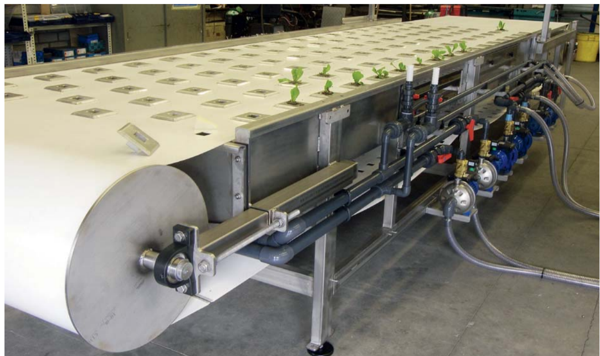
De opstelling in de werkplaats in Uden. De teeltband kan in principe onbeperkt verlengd worden. Het is de bedoeling om een stelling aan het begin van de teelt in één keer vol te draaien en het gewas ook in één keer te oogsten.
