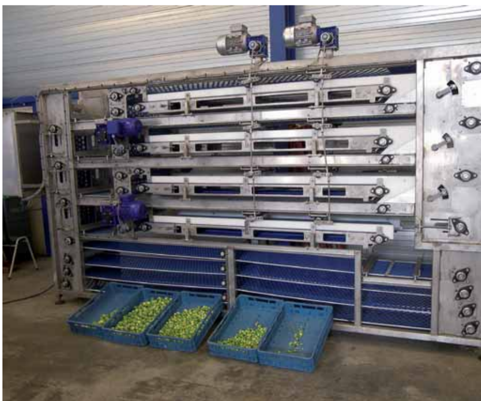
De GEGER-sorteerder is 3,5 meter lang en 54 centimeter breed: breed meer sorteringen betekent meer etages.
