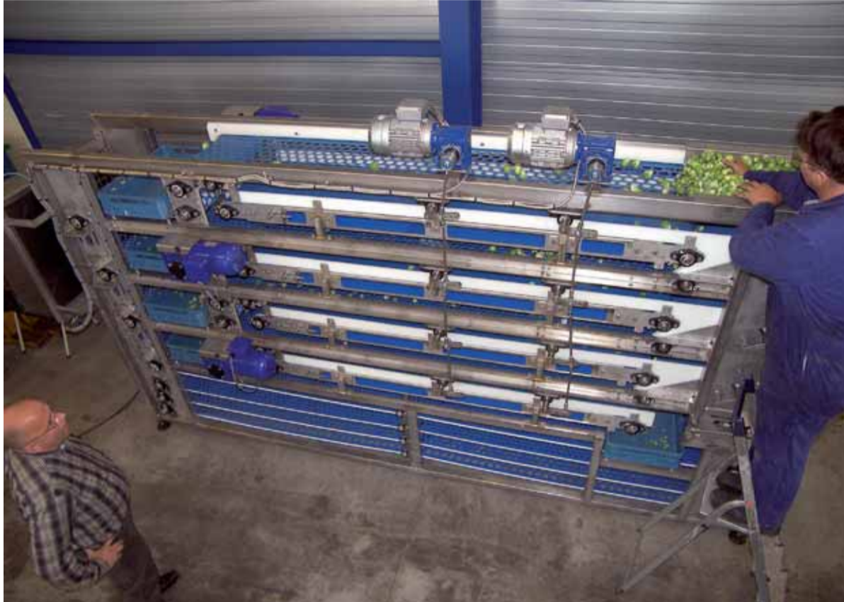
Het meest volumineuze deel van de spruiten wordt in het begin van het traject uitgesorteerd en afgevoerd.
