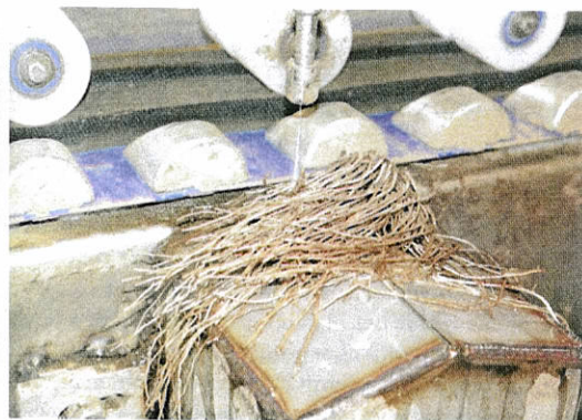
Het mes: een straaltje kraanwater van 0,12 millimeter dik, met 3.600 bar druk. Het spuitdopje is gemaakt van keramisch materiaal.
