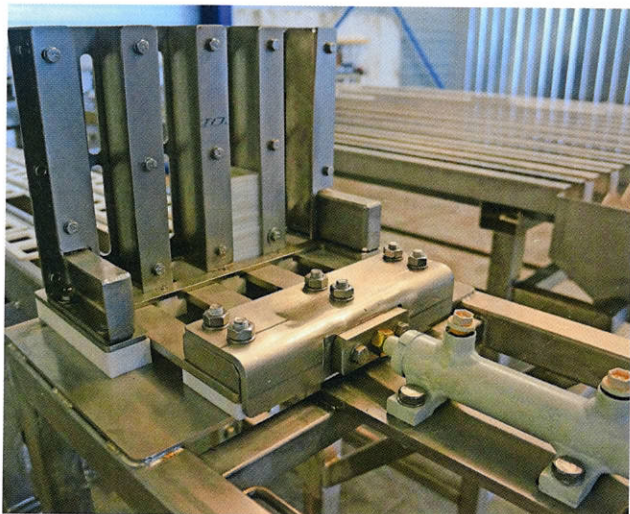
3: de raampjes liggen gestapeld in voorraadhouders. Een uitdrukunit drukt ze steeds per vier stuks op de goten.
