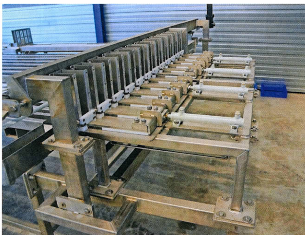
5: een uitdrukker drukt de afstandplaatjes een voor een op de goot, tegelijk met die beweging wordt ook een plant op deze goot gedrukt. De plaatjes (hier niet te zien) liggen op voorraad in houders.
