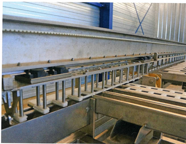
4: de raampjes met gewas worden met vier stuks tegelijk in een over- zethouder opgevangen en (zijwaarts) getransporteerd naar wijder uit elkaar liggende goten.
